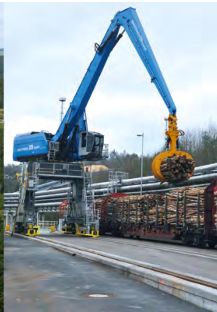
der erweiterten Anlage: einem neuen Terminal samt elektrobetriebenem Portalkran für die Entladung von Rundholzwaggons. Von dort geht das Holz direkt in die Weiterverarbeitung. Bis 2017 fuhren jährlich noch rund 60.000 Lkw mit Rundholz und Hackschnitzeln aus der Region zum Werksgelände. Beim Rundholz ist der Anteil der Lkw-Transporte stark rückläufig.
