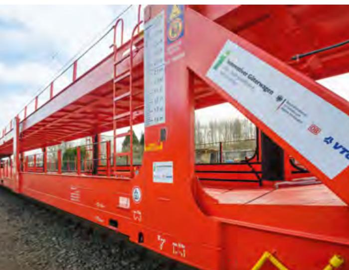
Der Autotransporter verfügt über eine flexibel anpassbare obere Ladefläche und unten über verstellbare Elemente.
