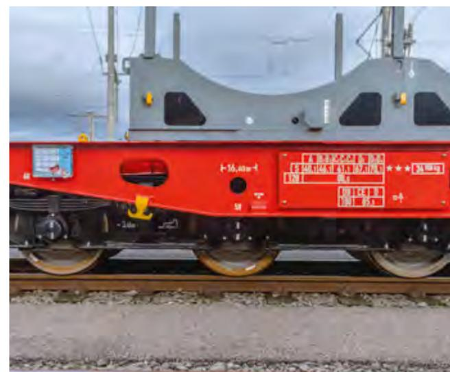
DB Cargo entwickelte den multifunktionalen sechsachsigen Flachwagen für den Transport von Stahlprodukten und Containern.
