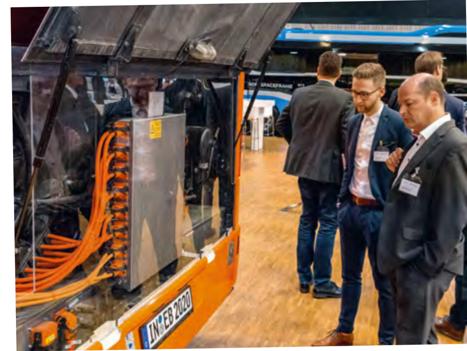
Zweites Leben als E-Bus: Dieses Fahrzeug (r.) wurde vom Diesel- auf den Batterieantrieb umgerüstet.
