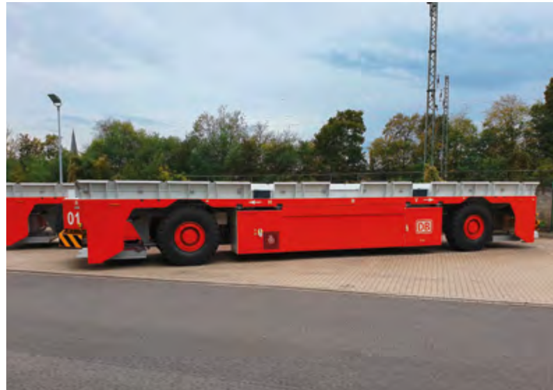
Das fahrerlose Transportsystem wird die Container aufnehmen und rechnergesteuert direkt bis zum Tragwagen des Anschlusszuges bringen. Das ebenfalls automatische Kransystem besorgt dann den schnellen Umschlag.
