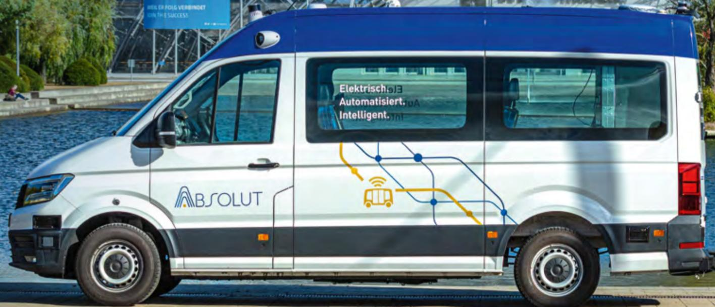
*In Leipzig wurde ein eCrafter für das hochautomatisierte Fahren als Entwicklungs- und Testplattform aufgebaut, für den öffentlichen Straßenraum zugelassen und erprobt – mit einem Sicherheitsfahrer als Rückfallebene.*
