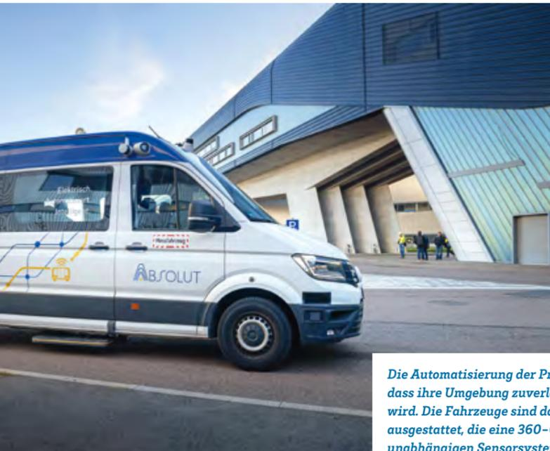
Die Automatisierung der Projektfahrzeuge setzt voraus, dass ihre Umgebung zuverlässig erfasst und ausgewertet wird. Die Fahrzeuge sind dafür mit diversen Sensoren ausgestattet, die eine 360-Grad-Abdeckung mit drei unabhängigen Sensorsystemen ermöglichen.
